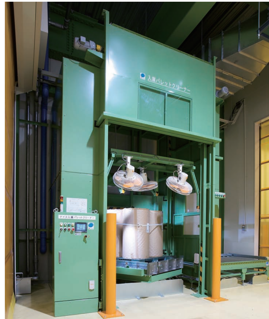
エアを噴射して、パレットごと塵や埃を落とす入庫パレットクリーナー
