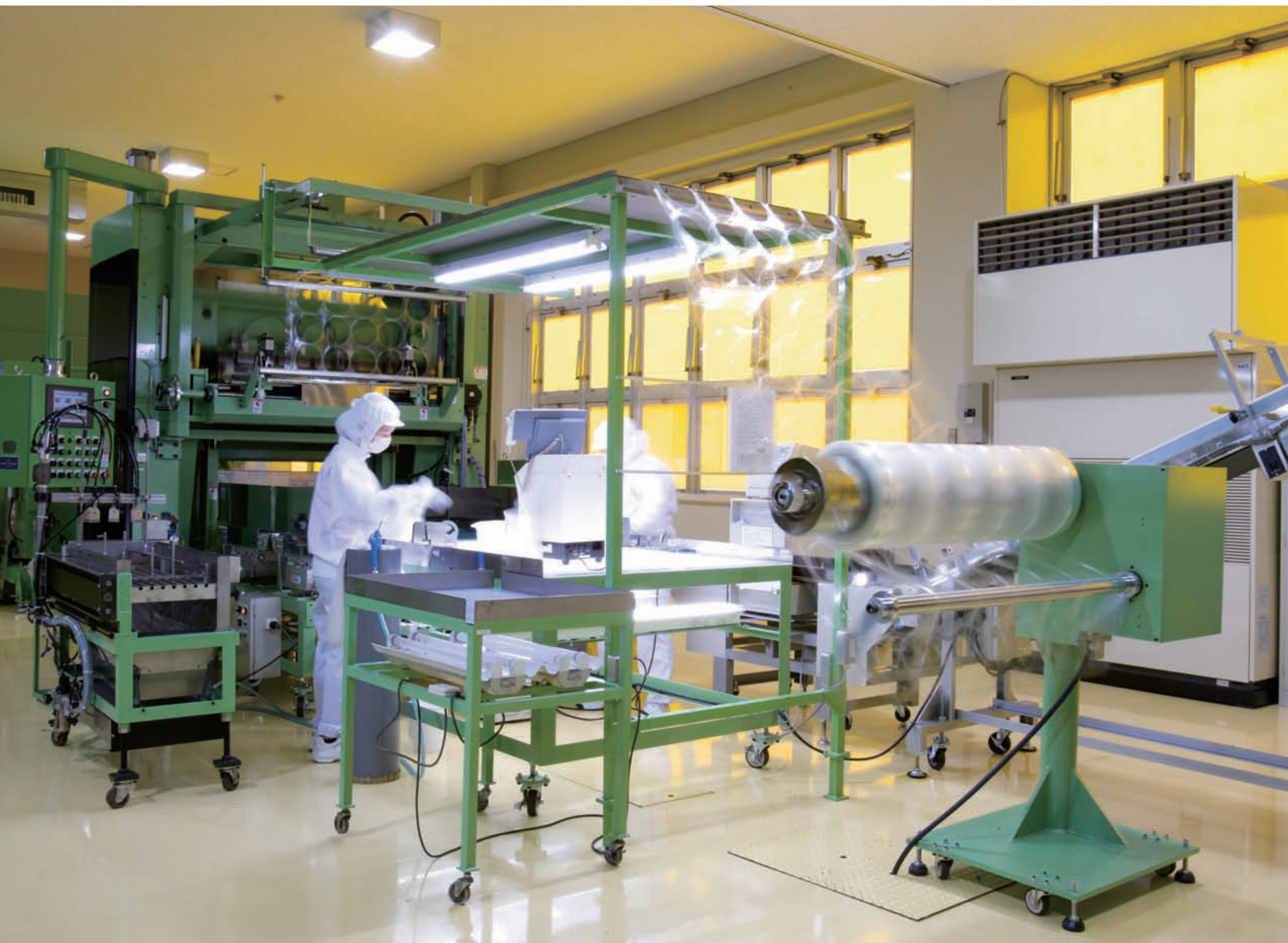
成型から打抜き、包装まで自動化する一貫した生産ライン
