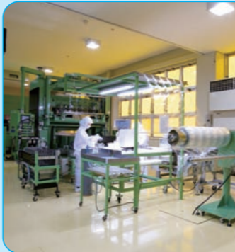
成型から打抜き、包装まで自動化する一貫した生産ライン
